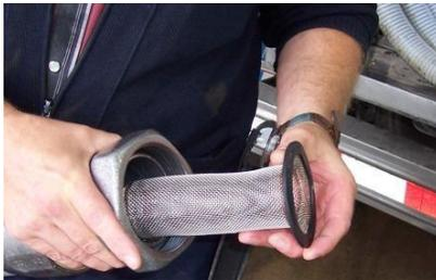
3. Placer le joint d'étanchéité
