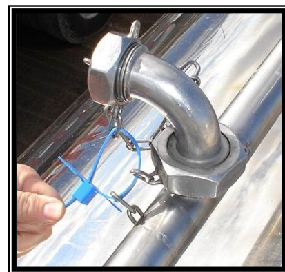
Un scellé sur la ou les extrémités de la tuyauterie du système de lavage en place.
