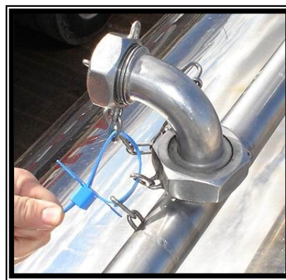
Un scellé sur la ou les extrémités de la tuyauterie du système de lavage en place.
